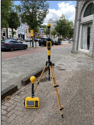
Figuur 1: Foto van de breedbandige outdoor meetopstelling
