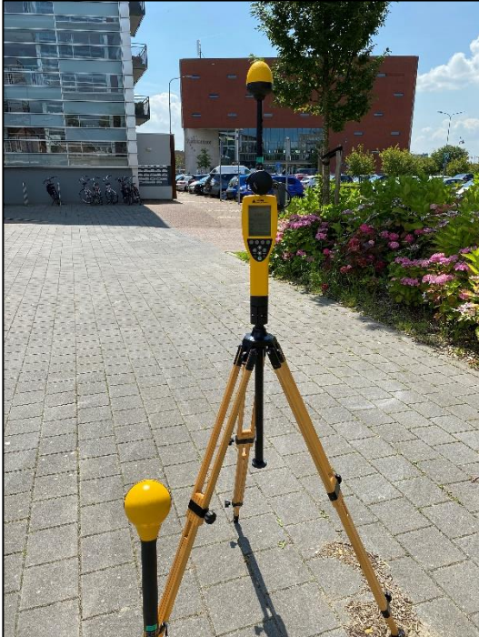
Figuur 1: Foto van de breedbandige outdoor meetopstelling
