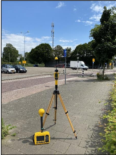
Figuur 1: Foto van de breedbandige outdoor meetopstelling
