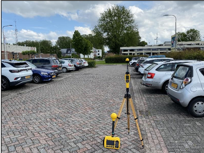
Figuur 1: Foto van de breedbandige outdoor meetopstelling
