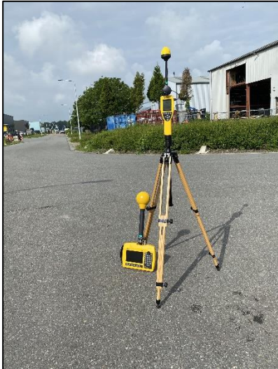
Figuur 1: Foto van de breedbandige outdoor meetopstelling
