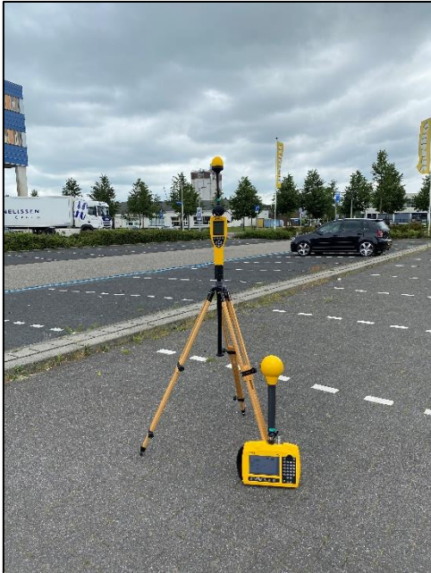
Figuur 1: Foto van de breedbandige outdoor meetopstelling
