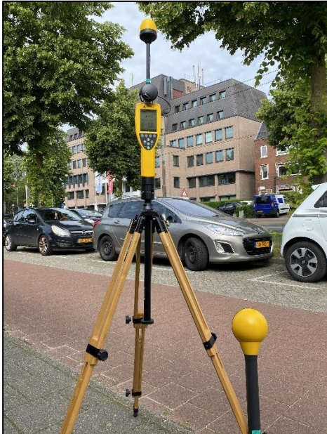
Figuur 1: Foto van de breedbandige outdoor meetopstelling
