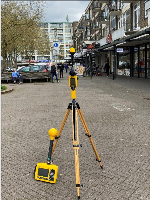
Figuur 1: Foto van de breedbandige outdoor meetopstelling
