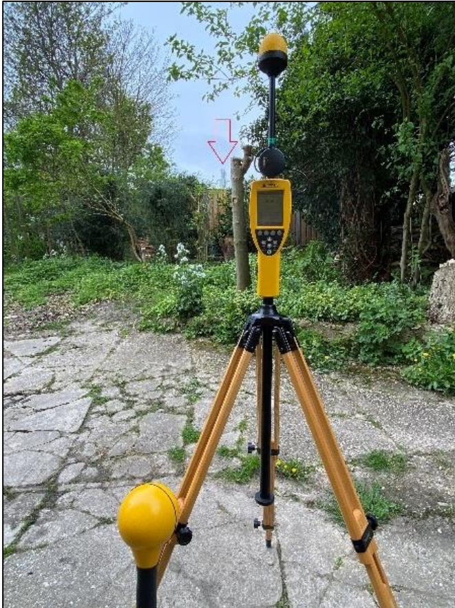
Figuur 1: Foto's van de breedbandige outdoor meetopstelling
