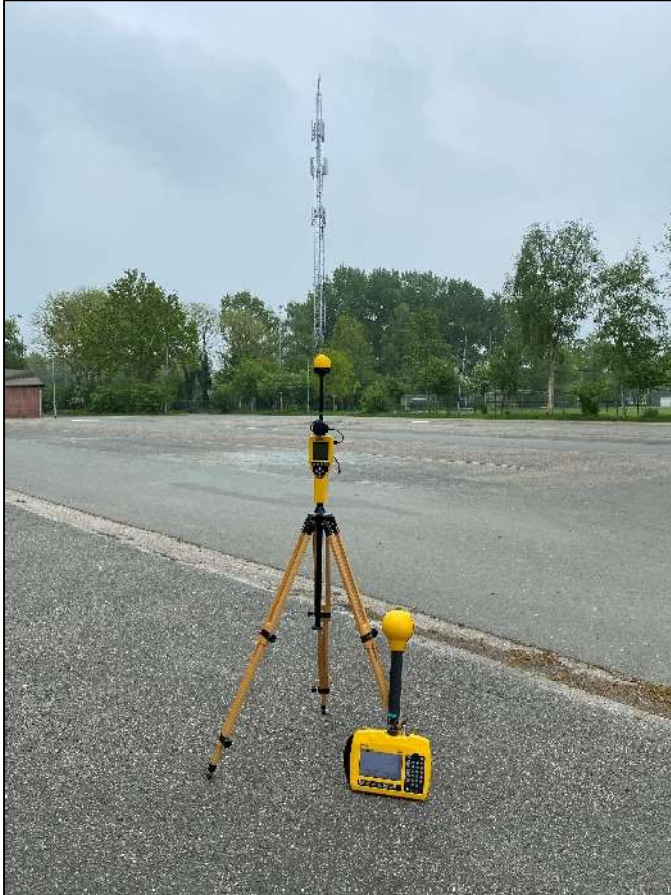
Figuur 1: Foto van de breedbandige outdoor meetopstelling
