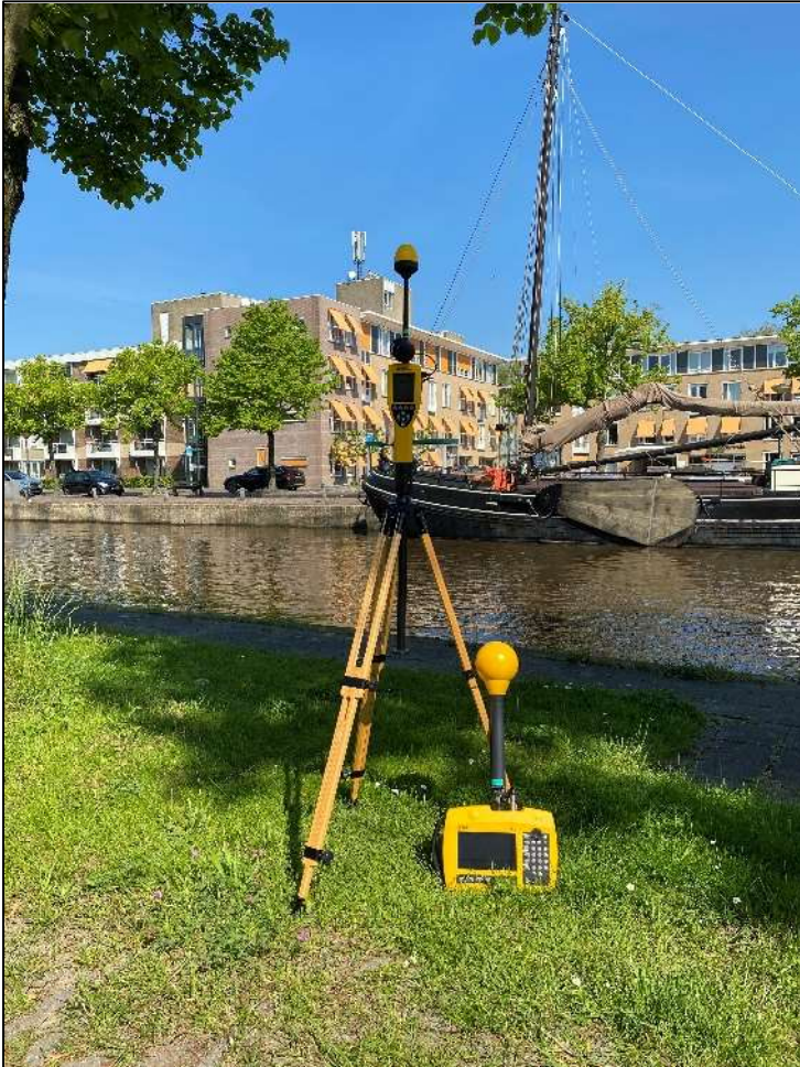
Figuur 1: Foto van de breedbandige outdoor meetopstelling
