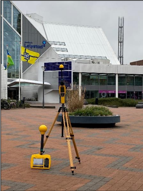
Figuur 1: Foto van de breedbandige outdoor meetopstelling
