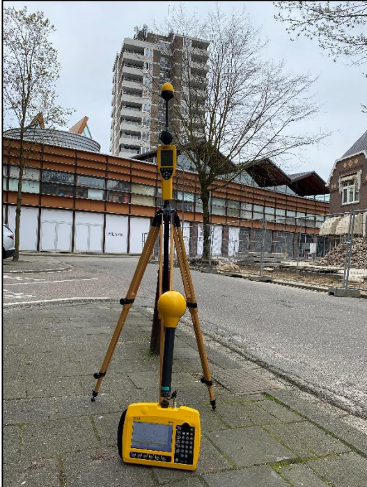
Figuur 1: Foto van de breedbandige outdoor meetopstelling
