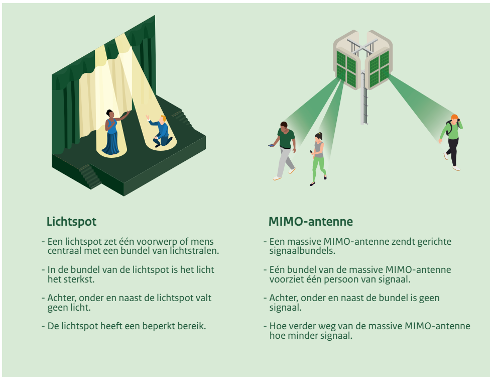
Figuur 2: Een massive MIMO-antenne schijnt als een lichtspot
