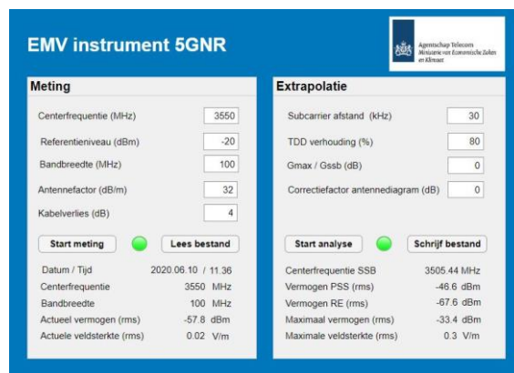
Figuur 6. De analyseresultaten van het 5G NR broadcast-signaal te Nuenen met behulp van een real-time spectrum analyzer.
