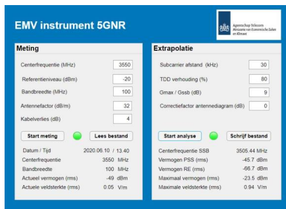
Figuur 14. De analyseresultaten van het 5G NR broadcast-signaal te Helmond met behulp van een real-time spectrum analyzer.
