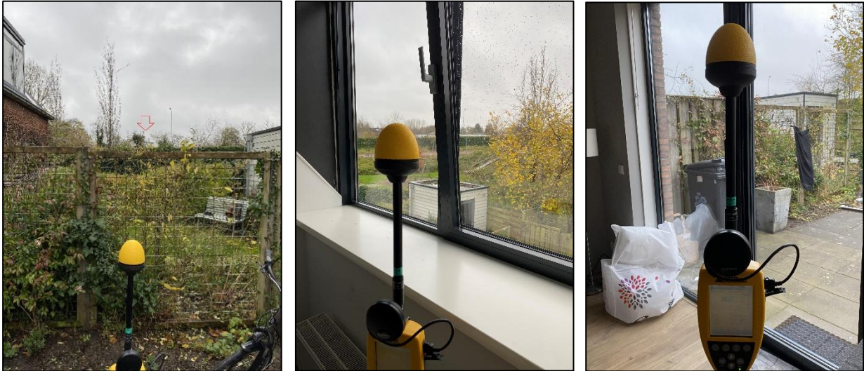
Figuur 1: Foto's van de breedbandige in- en outdoor meetopstellingen
