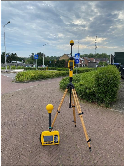
Figuur 1: Foto van de breedbandige outdoor meetopstelling
