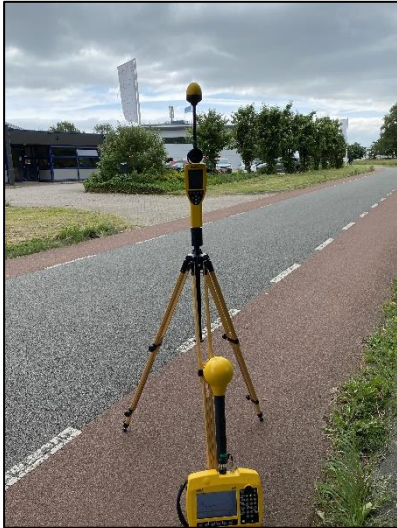
Figuur 1: Foto van de breedbandige outdoor meetopstelling
