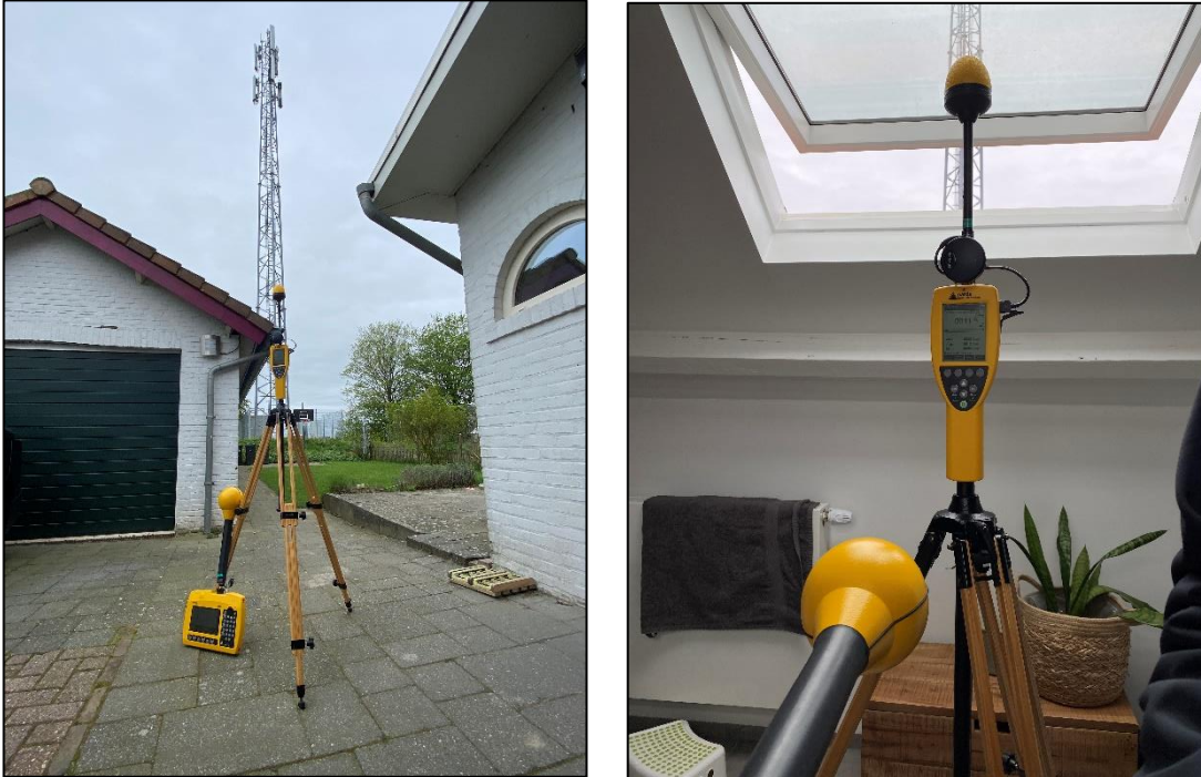
Figuur 1: Foto's van de breedbandige in- en outdoor meetopstellingen
