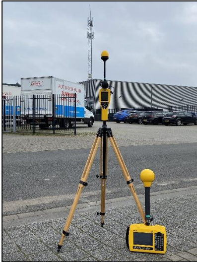
Figuur 1: Foto van de breedbandige outdoor meetopstelling
