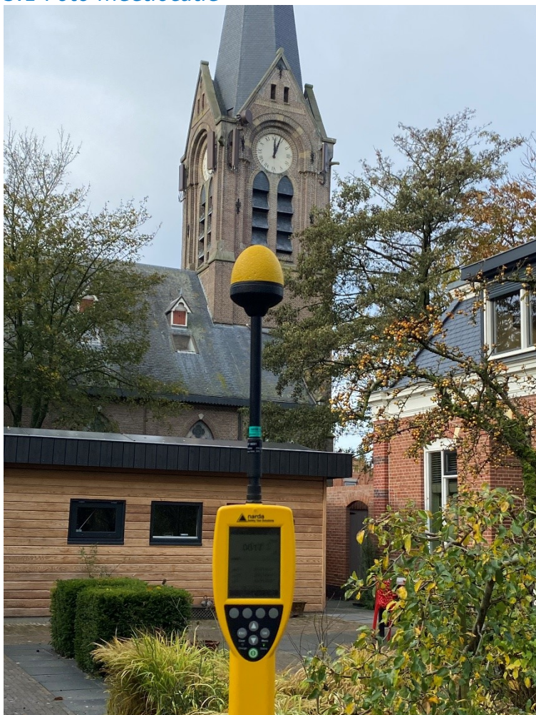
Figuur 1: Foto van de breedbandige outdoor meetopstelling
