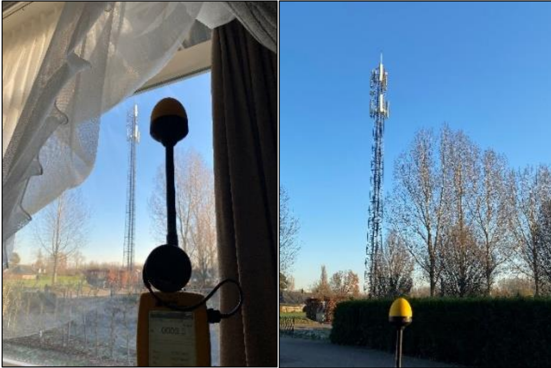
Figuur 1 en 2: Foto's van de breedbandige outdoor en indoor meetopstelling
