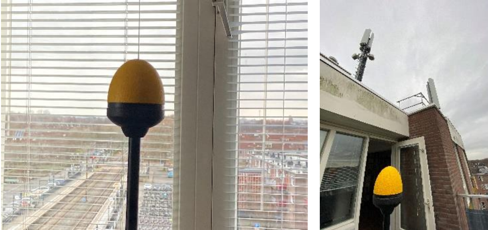
Figuur 1 en 2: Foto's van de breedbandige outdoor en indoor meetopstelling
