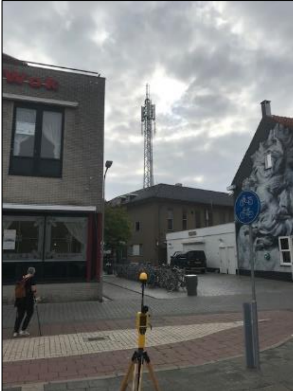
Figuur 1: Foto van de breedbandige outdoor meetopstelling
