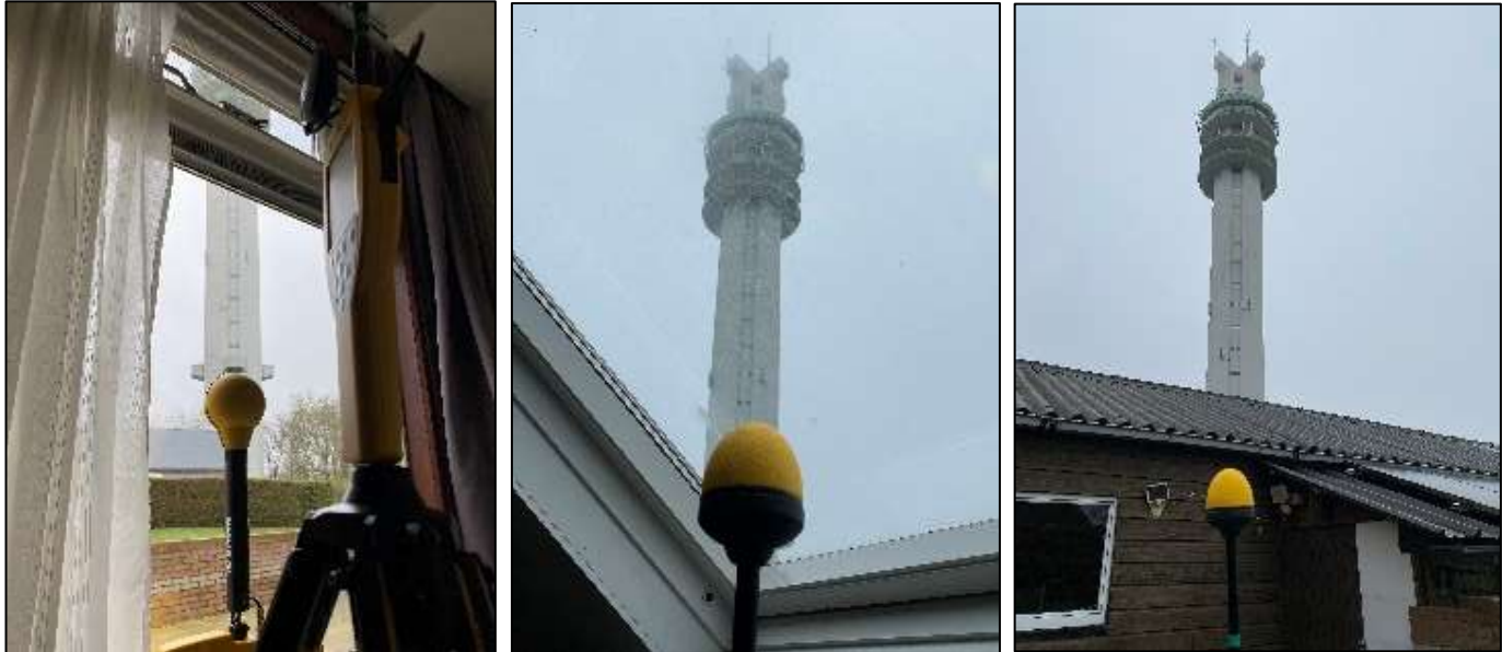
Figuur 1, 2 en 3: Foto's van de breedbandige outdoor en indoor meetopstelling
