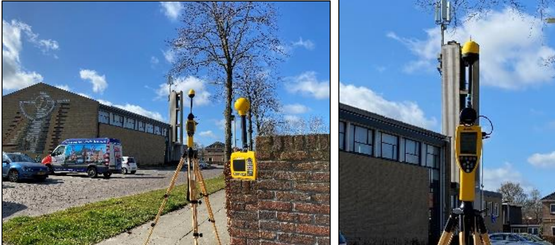
Figuur 1 en 2: Foto's van de breedbandige outdoor meetopstelling.
