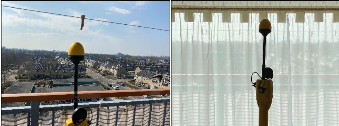
Figuur 1 en 2: Foto's van de breedbandige outdoor en indoor meetopstelling
