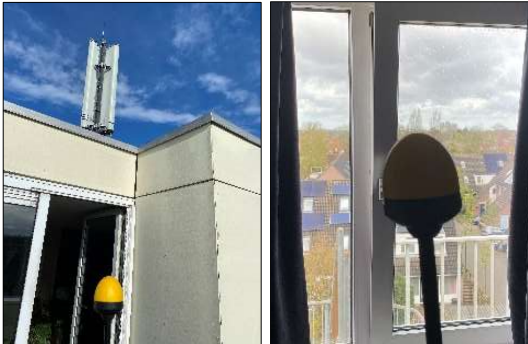
Figuur 1 en 2: Foto's van de breedbandige outdoor en indoor meetopstelling
