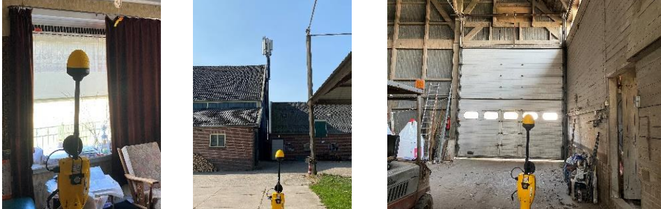
Figuur 1, 2 en 3: Foto's van de breedbandige outdoor en indoor meetopstelling
