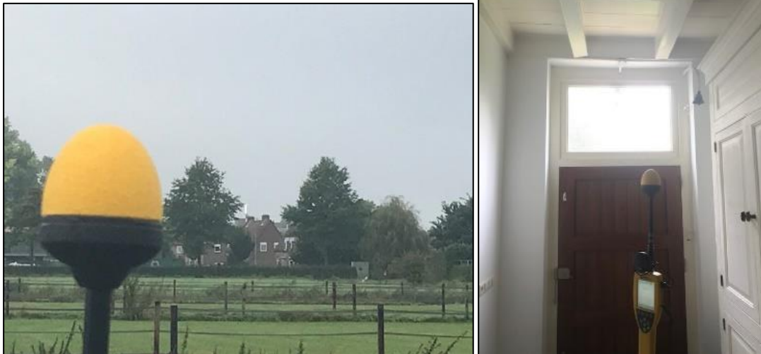
Figuur 1 en 2: Foto's van de breedbandige outdoor meetopstelling 1 en 2.
