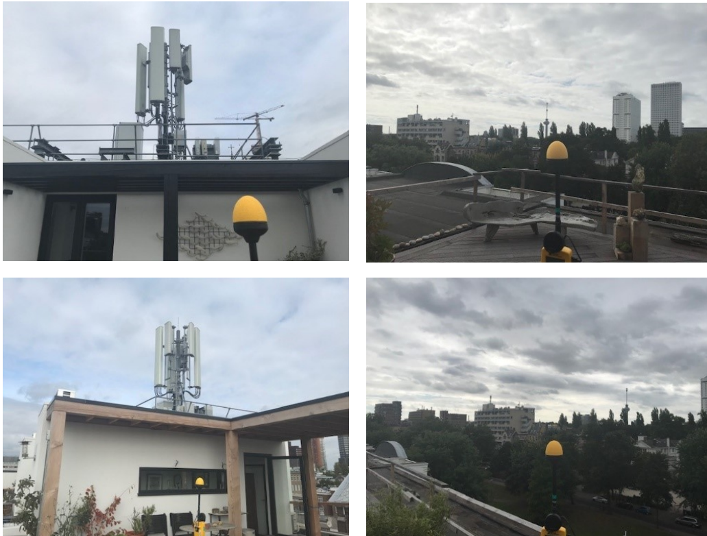
Figuren 1 t/m 4: Foto's van de breedbandige outdoor meetopstelling 1 en 2.
