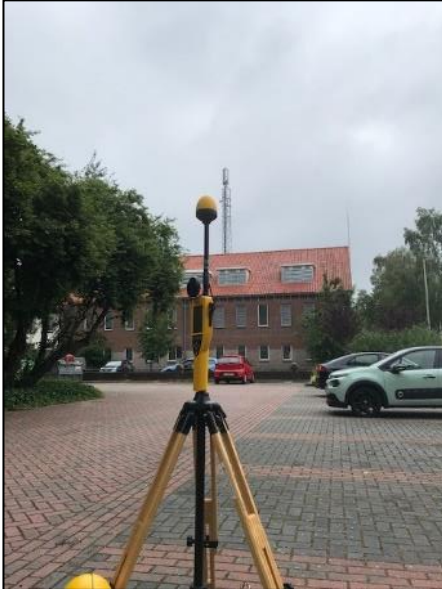
Figuur 1: Foto van de breedbandige outdoor meetopstelling
