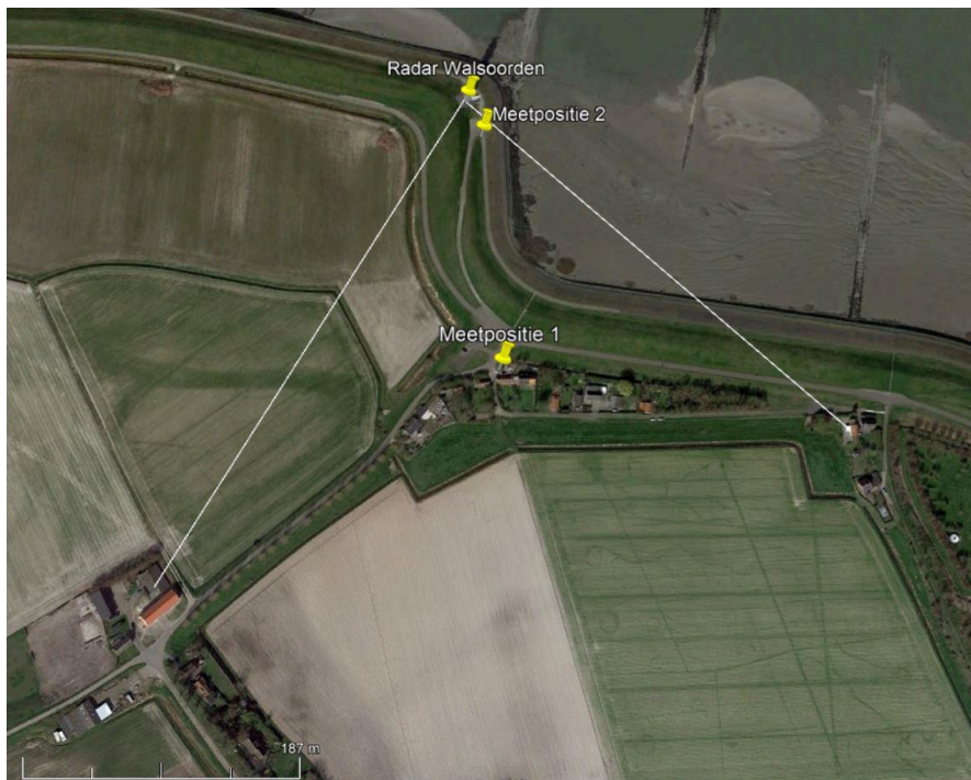
Figuur 2: Radarpost Walsoorden, meetposities 1 en 2 en de blanking sector
