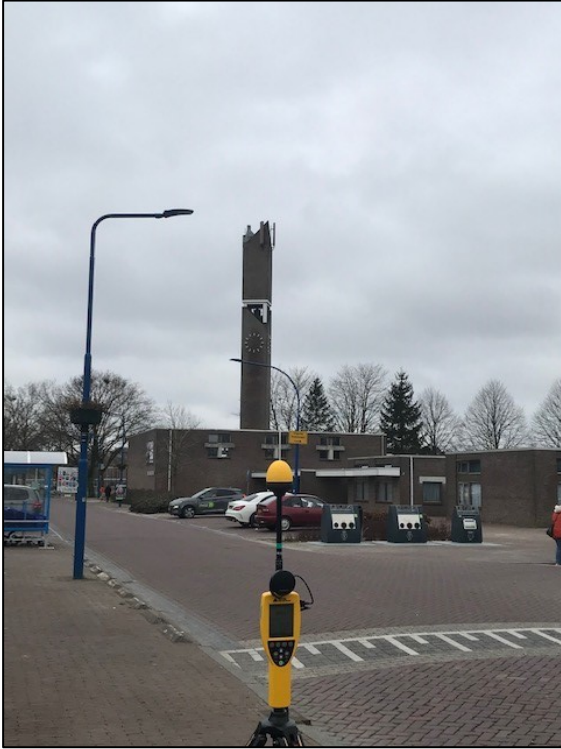
Figuur 1: Foto van de breedbandige outdoor meetopstelling
