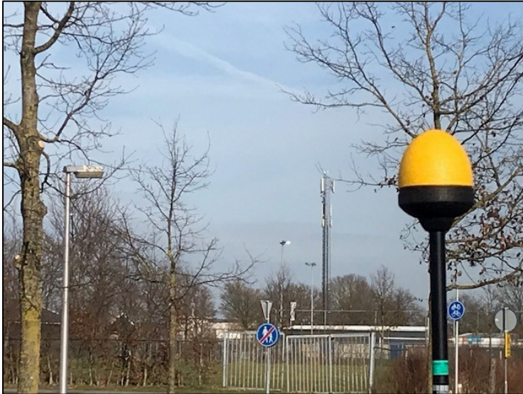
Figuur 1: Foto van de breedbandige outdoor meetopstelling
