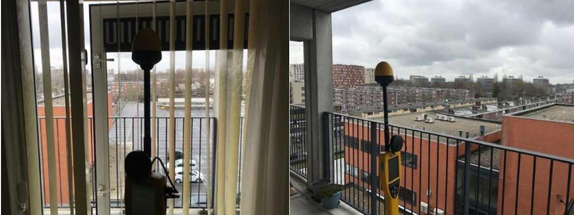
Figuur 1 en 2: Foto's van de breedbandige in- en outdoor meetopstelling
