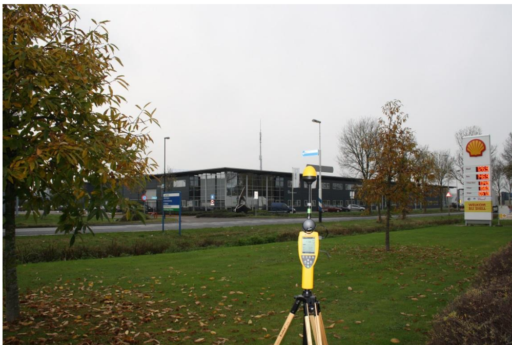
Foto 1: Opstelpunt breedbandige meting Nobisstraat, op de achtergrond antennemast 1, Stikker te Asten.
