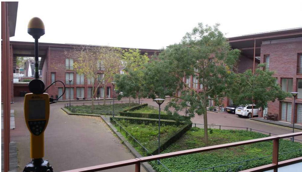
Foto 1: Opstelpunt breedbandige meting op het balkon ter hoogte van de woonkamer.
