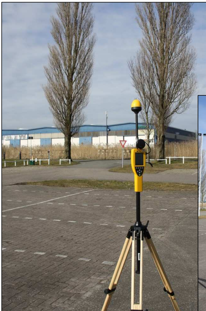
Foto 3. Inzet, zelfde meetopstelling als bij foto2, met daarop de vrijstaande mast voor P- en C 2000.
