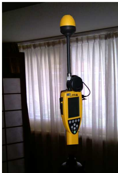
Foto 1: Meetopstelling breedbandmeting slaapkamer 1 e verdieping.
