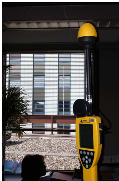
Foto 1: Meetopstelling breedbandmeting kamer 2162 gemeentehuis Amersfoort.
