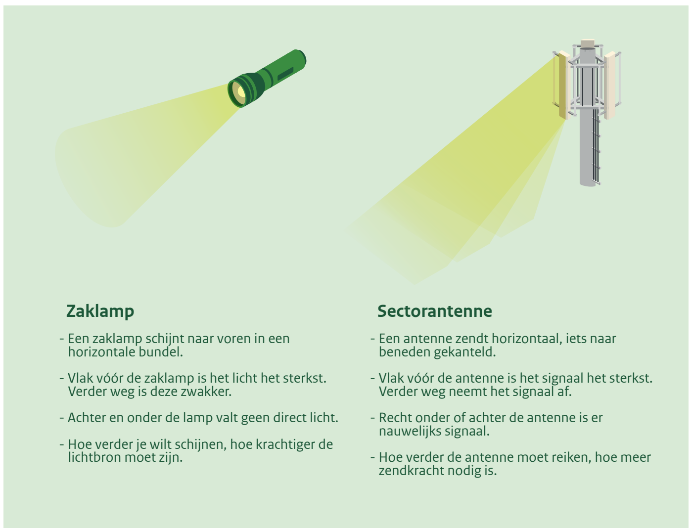
Figuur 1: Een sectorantenne voor mobiele communicatie schijnt als een zaklamp
