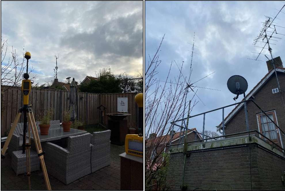
Figuur 1 en 2: Foto's van de breedbandige outdoor meetopstelling en de antenne-installatie van de radiozendamateur
