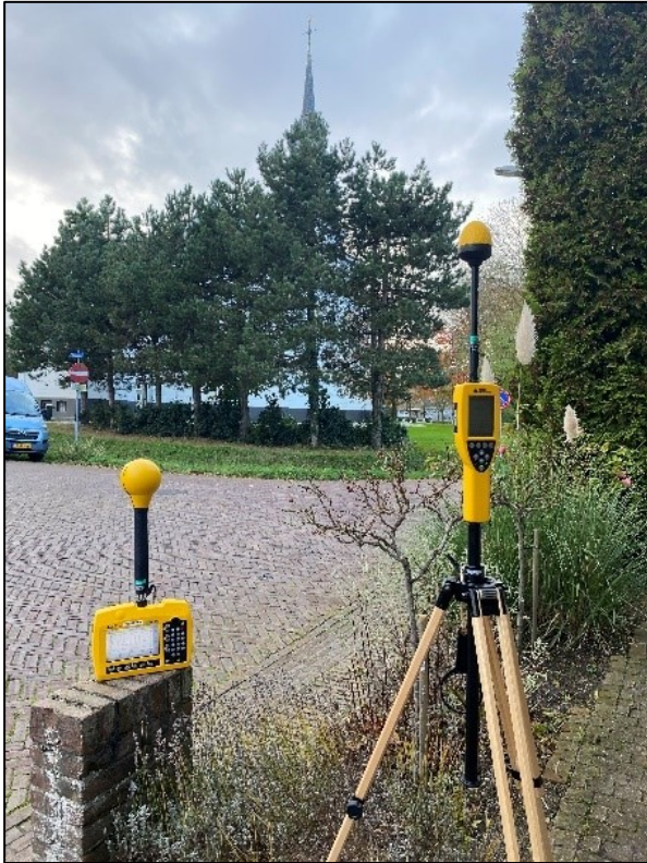
Figuur 1: Foto van de breedbandige outdoor meetopstelling
