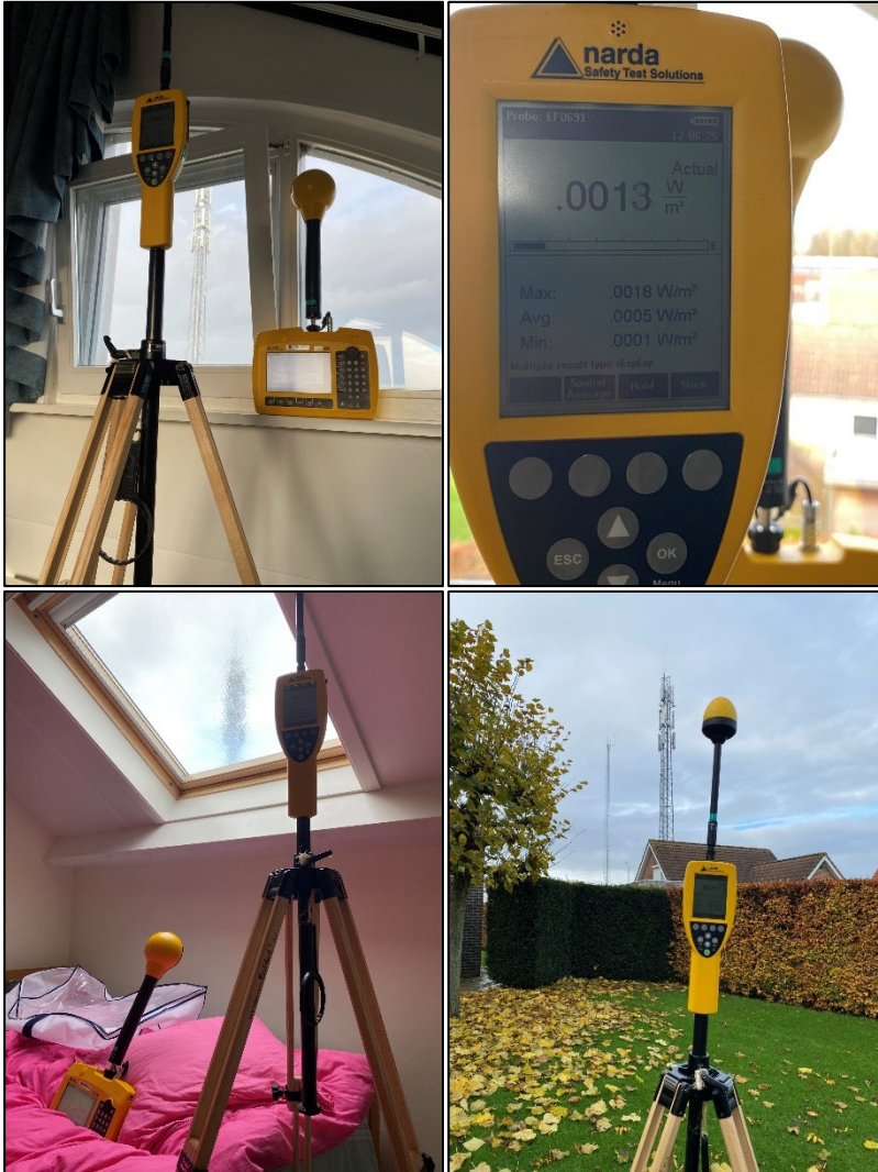
Figuur 1, 2, 3 en 4: Foto's van de breedbandige indoor en outdoor meetopstelling
